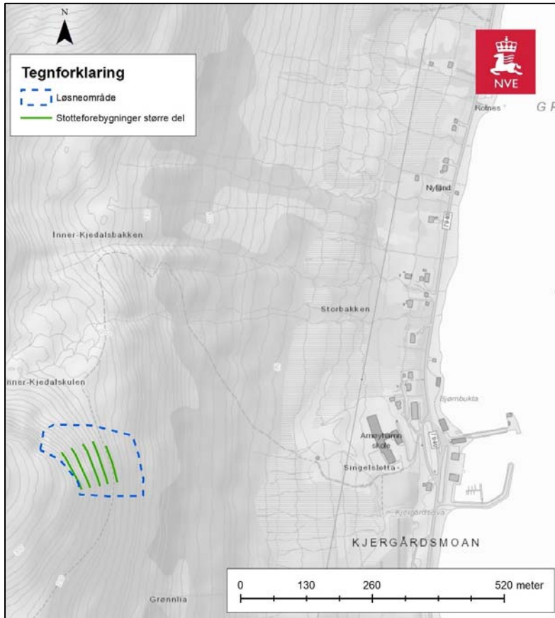
Figur 14: Ved å etablere 5 rekker med støtteforebygninger sentralt i løsneområdet vil skolen kunne sikres mot skred med
