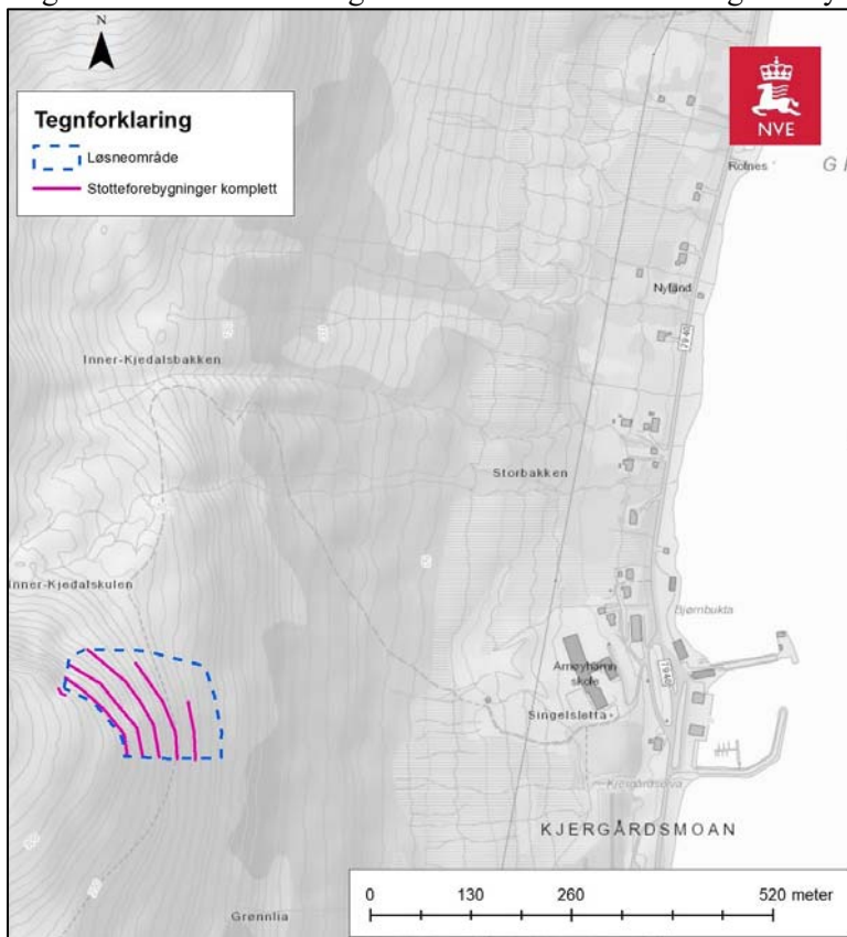
Figur 8: Ved å dekke løsneområdet med støtteforebygninger vil man sikre skolen mot skred med årlig sannsynlighet 1/5000. Det er behov for totalt 581 meter støtteforebygninger.
